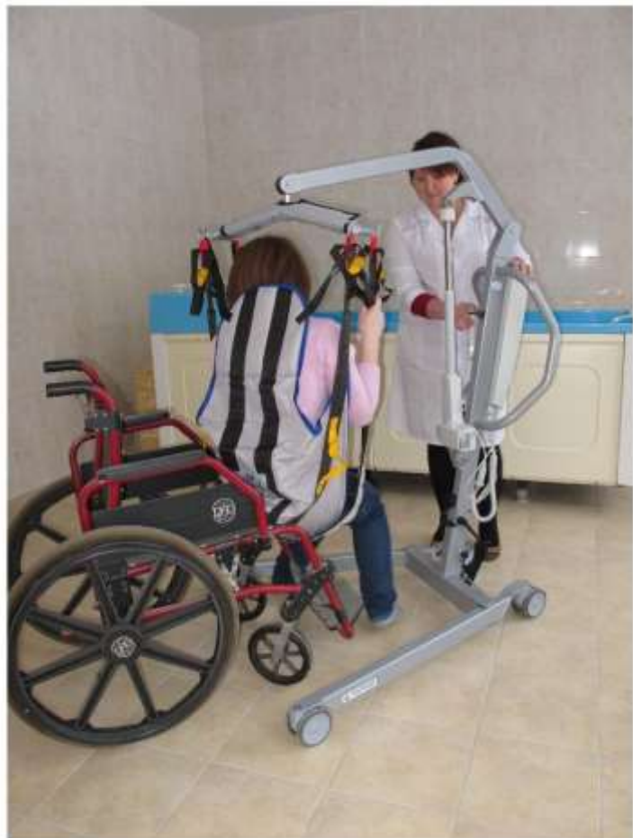
Устройство для подъёма и перемещения маломобильной категории инвалидов (подъёмник).
